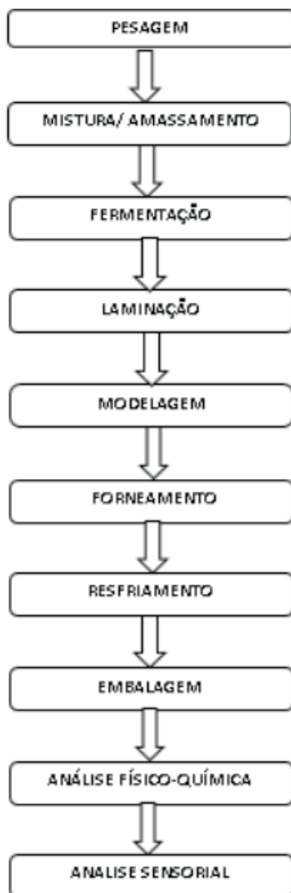
Figura 01- Fluxograma para elaboração dos biscoitos com adição de farinha de alfarroba ( Ceratonia siliqua L. ).
