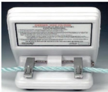
O HI-Test Testador de cordas tem o objetivo de testar cordas, fitas e cintas para trabalhos em LINHA-VIVA quanto a INTEGRIDADE Di-elétrica no período e local que ela está em uso.
