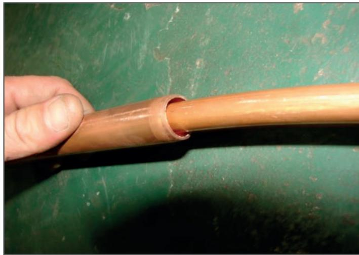
Figura 5: Fabricação do condensador de tubos duplos
