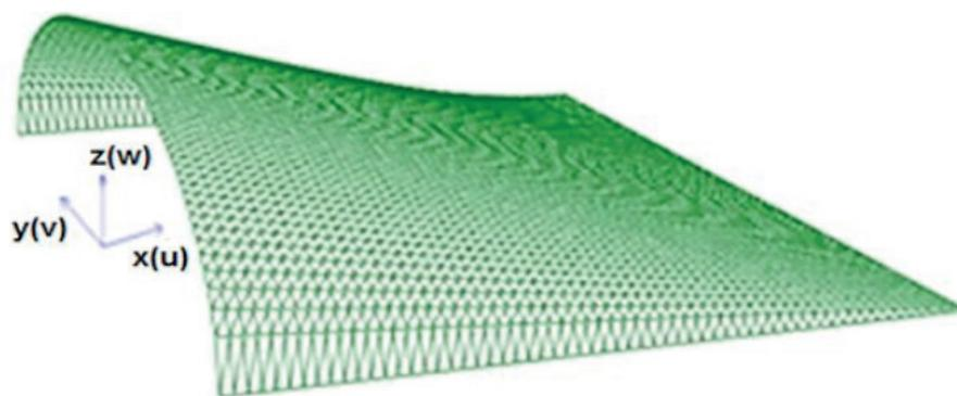
Figura 4- Malha de elementos finitos STRI 3 para Geometria 1.
