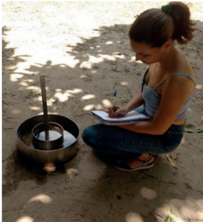
Figura 4. Realização do ensaio de infiltrômetro de anel.
