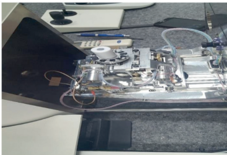
Figura 2: Imagem do equipamento utilizado para obter o EDX do aço
