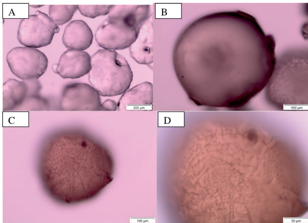
Figura 10- Imagens das microesferas de quitosana obtidas por microscopia óptica. (a) e (b) microesferas de Quitosana e (c) e (d) microesferas tratadas com GA
