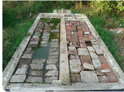
Figura 2: Biofiltos Submersos em situação operacional no período da pesquisa
