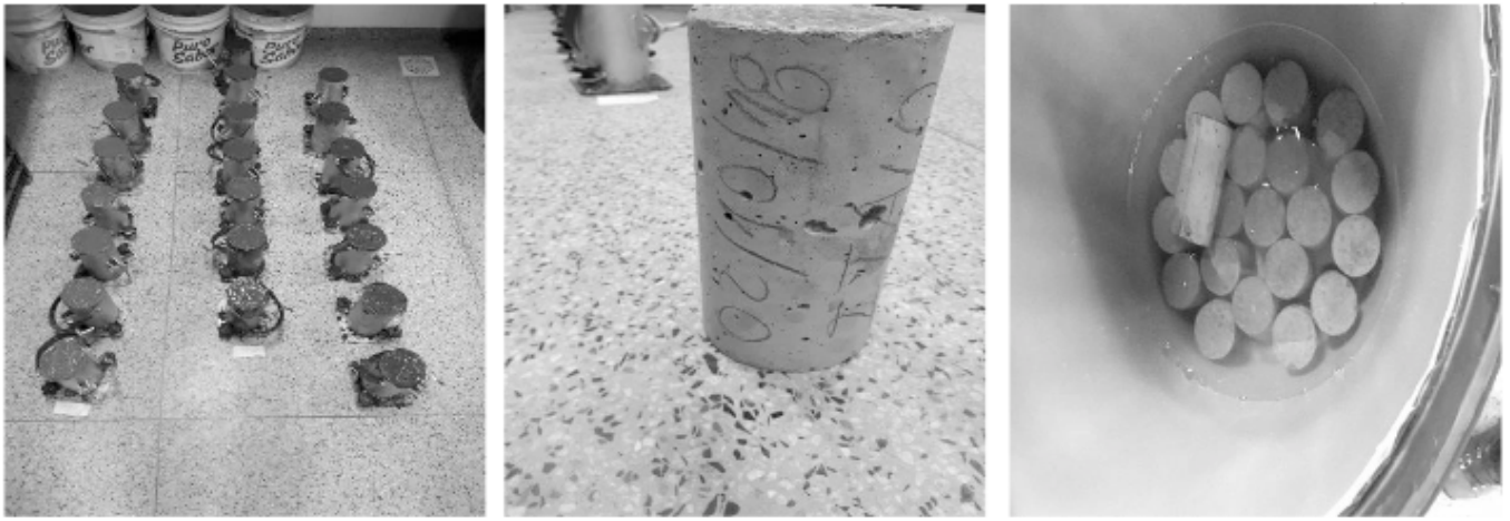
Figura 02 – Corpos de Prova (a) identificação dos corpos (b) e armazenamento (c).
