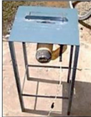
Figura 6. Máquina utilizada no corte dos corpos de prova.
