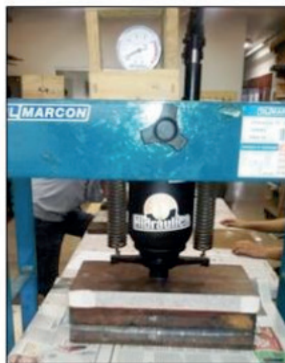
Figura 5. Prensa hidráulica utilizada na compressão.
