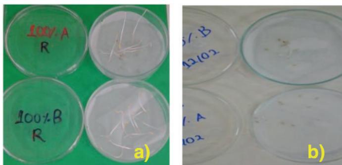
Figura 3: Germinação das sementes (a) Efluente real tratado e (b) efluente real bruto
