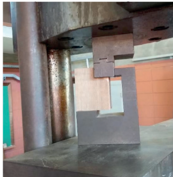
Figura 4 - Ensaio de cisalhamento paralelo às fibras segundo a norma ABNT NBR 7190: 1997
