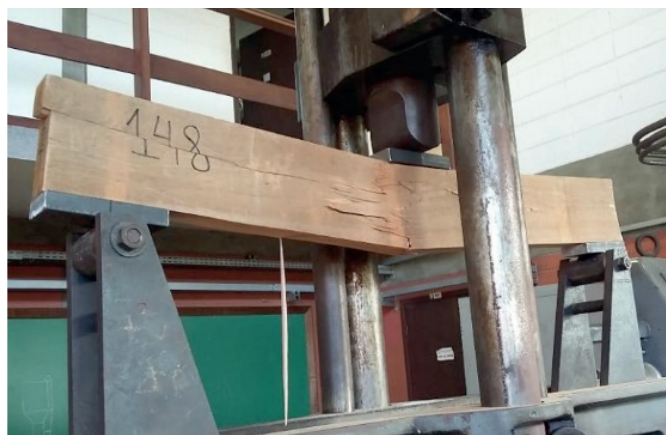
Figura 7 - Ruptura por cisalhamento
