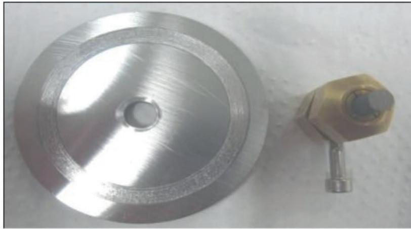
Figura 1. Pino e disco utilizados no ensaio.
