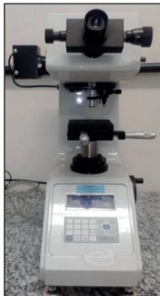
Figura 4. Microdurômetro.
