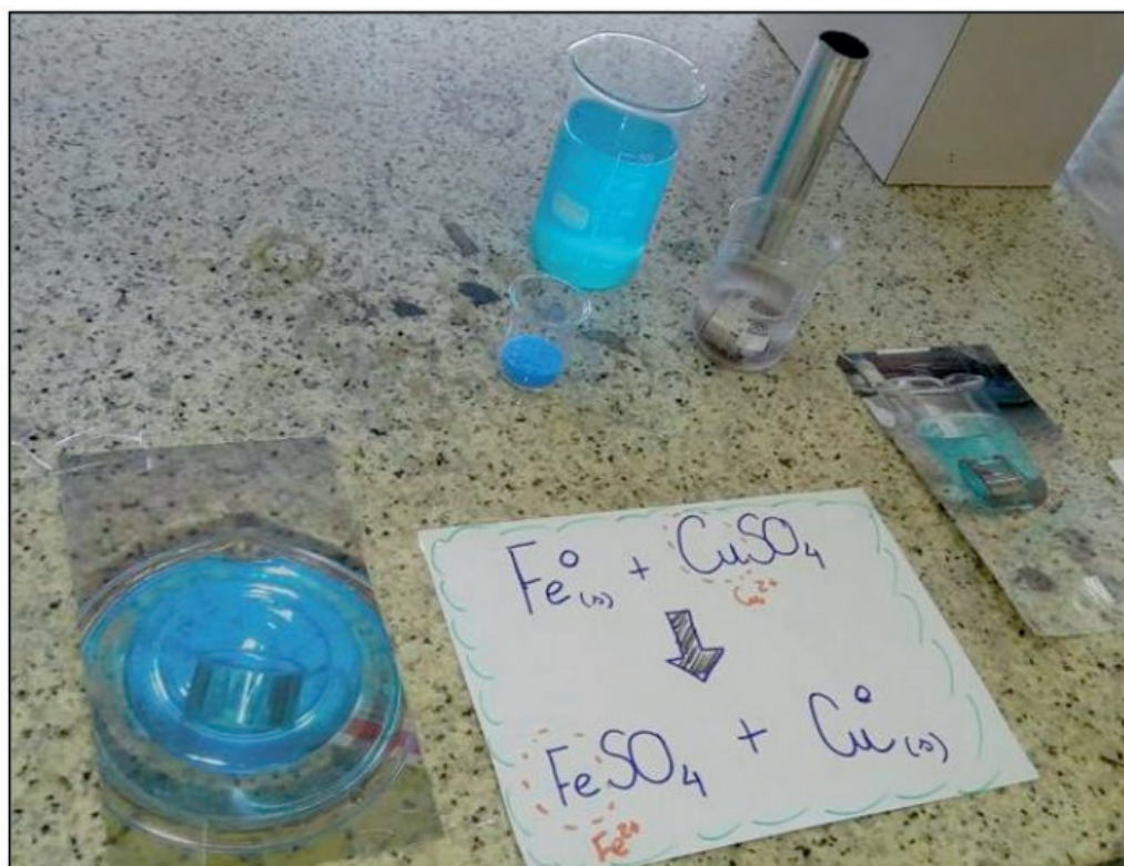
Figura 3. Experimento da reação de tubulação de inox com solução de sulfato de cobre.
