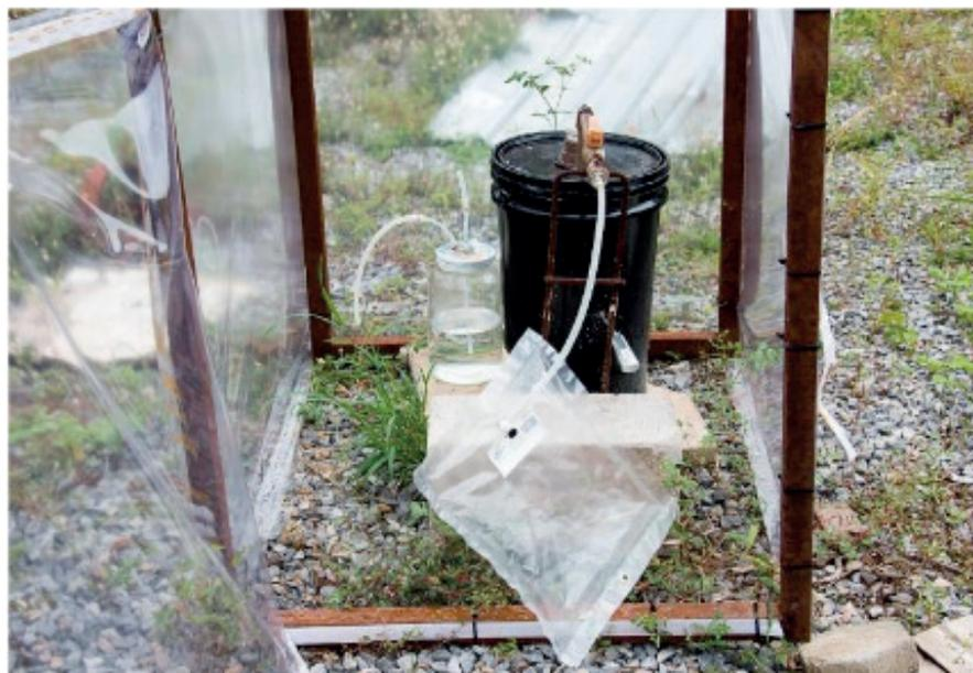
Figura 1. Recolhimento do biogás através do biodigestor caseiro
