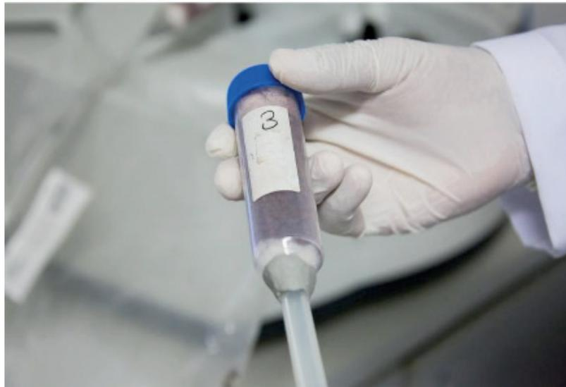
Figura 2. Nanofiltro redutor de  $H_2S$  e umidade do biogás
