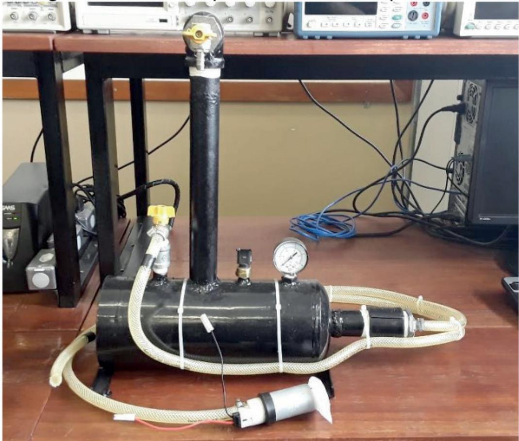
Figura 3 – Vaso de pressão destinado para testes
