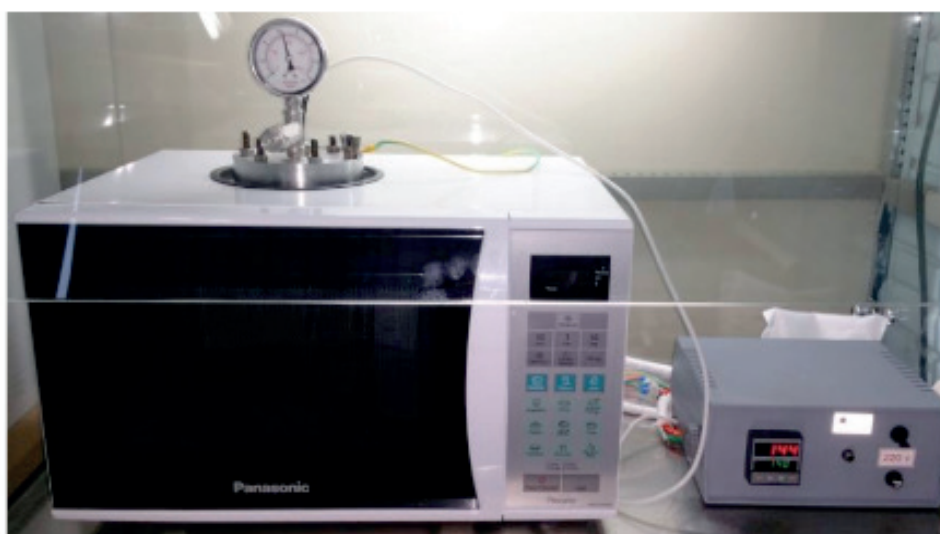
Figura 1 – Forno de micro-ondas adaptado para síntese pelo método HAM.
