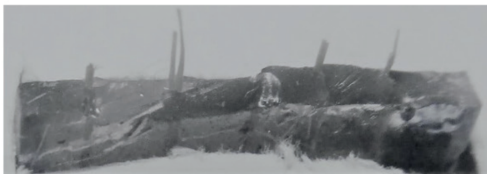
Figura 8. Superfície de fratura para os compósitos com espaçamento entre fibras de 2,5 mm ( \lambda_x = 2,5 mm).
