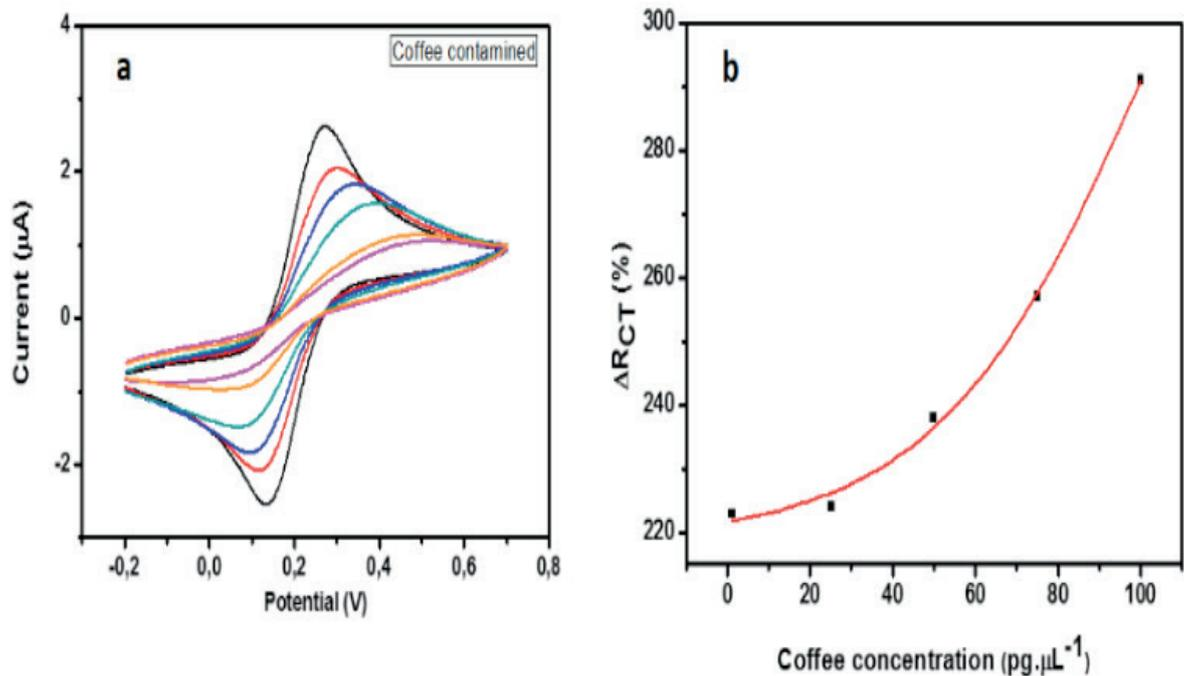
Figura 5. Avaliação eletroquímica do café. Voltametria cíclica (a): (-) aptasensor; (-) 1,0pg.mL<sup>-1</sup>; (-) 25,0 pg.mL<sup>-1</sup>; (-) 50,0 pg.mL<sup>-1</sup>; (-) 75,0 pg.mL<sup>-1</sup>; (-) 100,0 pg.mL<sup>-1</sup> e transferência de carga relativa (Rct%) em diferentes concentrações de OTA no café (b).
