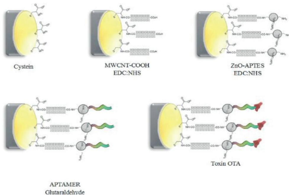
Figura1. Representação esquemática da montagem do Nanobiosensor.
