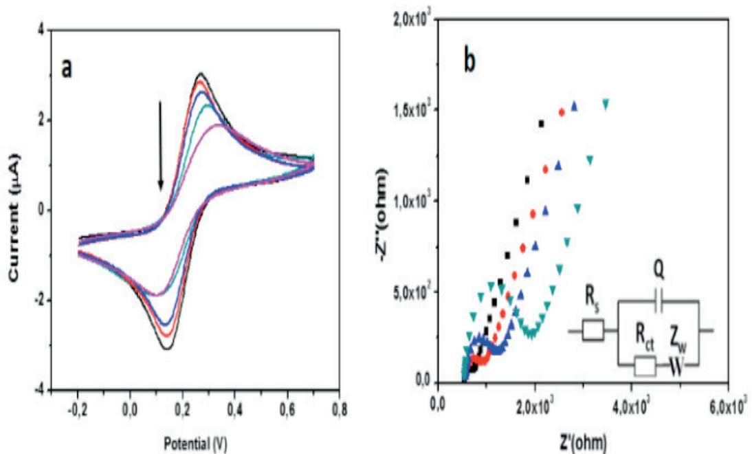
Figura 2. Voltamogramas cíclicos (a) e gráficos de Nyquist (b) para cada etapa na montagem do aptasensor. Inserção: Circuito equivalente usado para ajustar os resultados da impedância.
