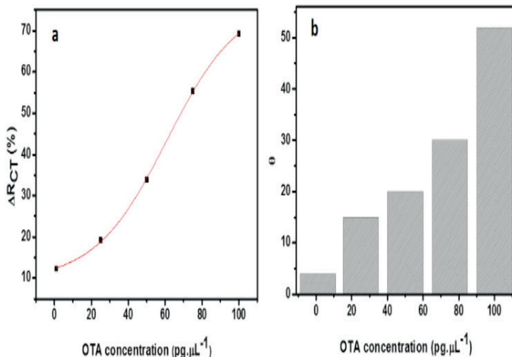
Figura 4. Transferência de carga relativa (Rct%) do aptasensor (a) e revestimento de superfície (b) para o aptasensor em relação às concentrações de OTA.
