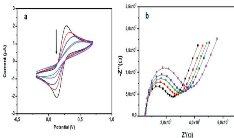
Figura 3. Voltamogramas cíclicos (a) e gráficos de Nyquist (b) do aptasensor após exposição a diferentes concentrações de OTA (1.0, 25.0, 50.0, 75.0 e 100.0 pg.uL<sup>-1</sup>): (■) 1.0pg.mL<sup>-1</sup>; (■) 25,0 pg.mL<sup>-1</sup>; (■) 50,0 pg.mL<sup>-1</sup>; (■) 75,0 pg.mL<sup>-1</sup>; (■) 100,0 pg.mL<sup>-1</sup>.
