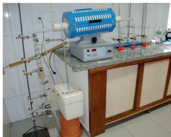
Figura 3: Sistema de pirólise do lodo – entrada de gás, tubo, conjunto de vidraria e lavadores de gases.
