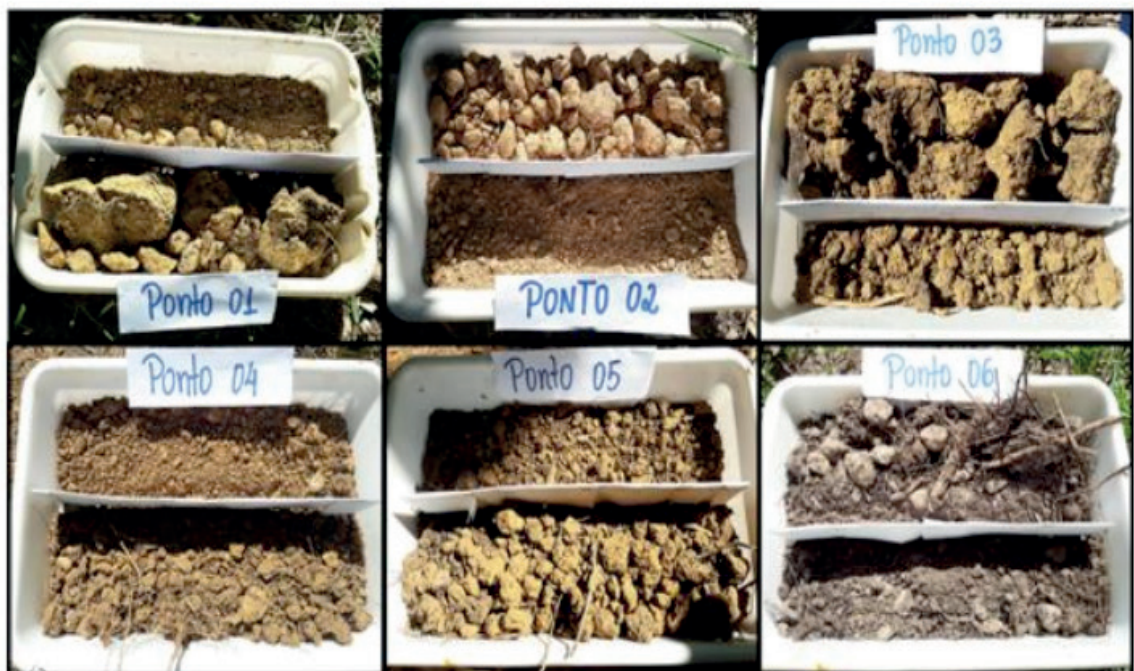
Figura 2. Identificação, separação de camadas de solo com características morfológicas distintas. Fonte: autores, 2018.
