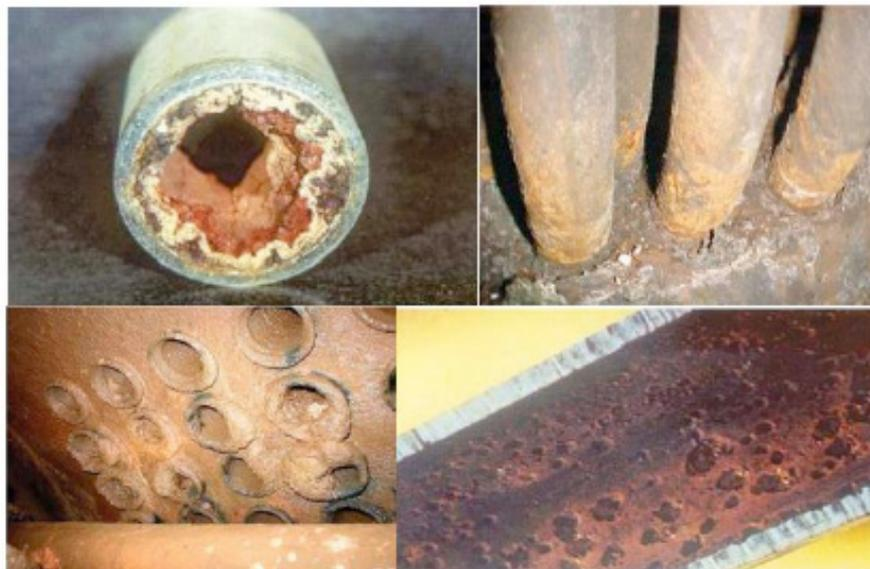
Figura 1 - Corrosão nas tubulações
