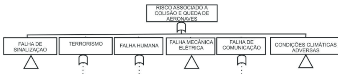
Figura 2 - Detalhe da análise do segundo nível associado ao Risco de colisão e queda de aeronaves.
