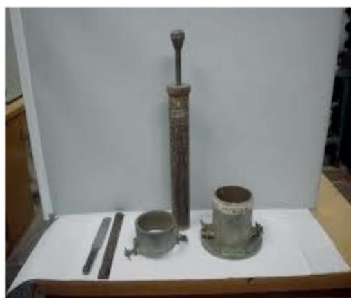
Figura 3. Soquete e Cilindro Proctor Normal
