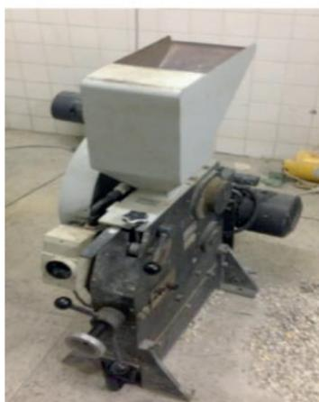
Figura 2. Triturador de Mandíbulas
