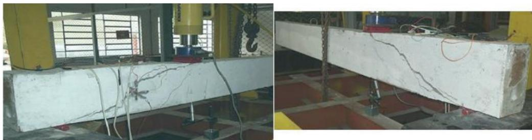
Figura 16 – Ruptura da Viga referencia
