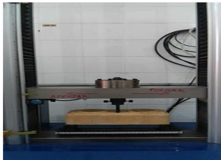
Figura 7. Ensaio em três pontos
