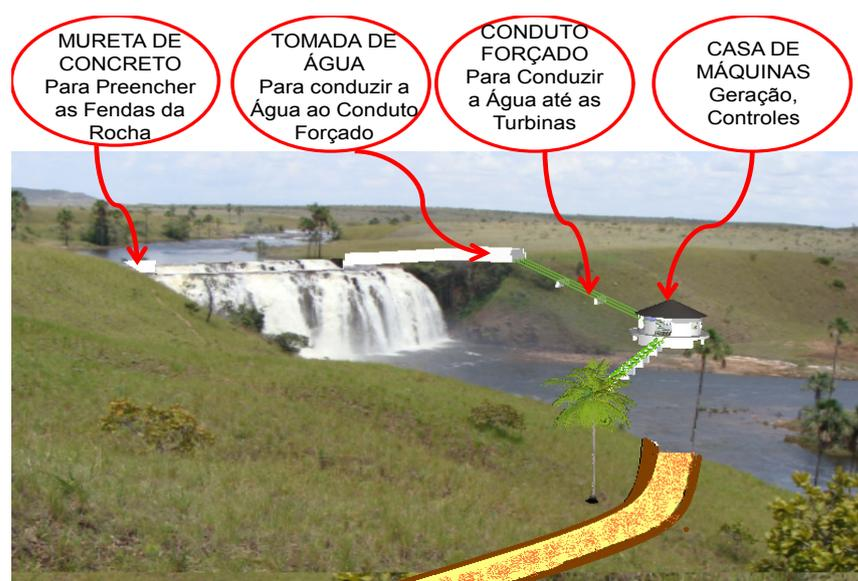
Figura 2: Prospecção do Arranjo da Mini-hidrelétrica da Andorinha
