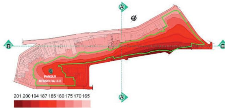
Figura 02- Mapa Topográfico com Indicação de Cortes
