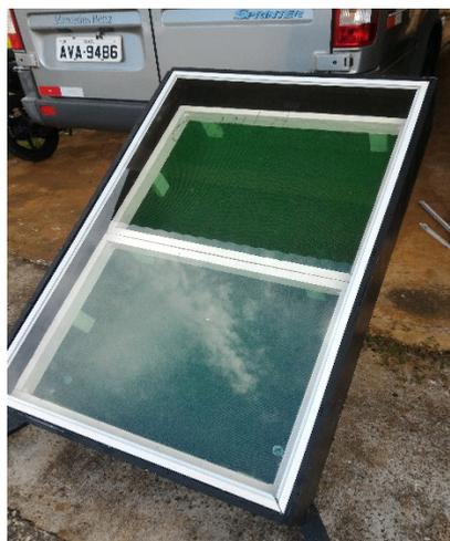
Ao longo do processo de secagem, foram monitoradas a temperatura e a umidade relativa no interior do secador solar, por meio de um termo-higrômetro digital.
