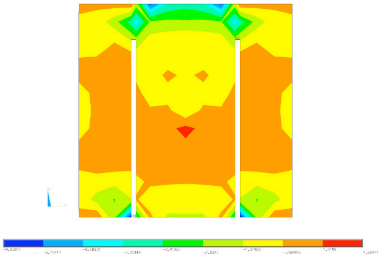
Figura 13 – Fluxo de tensões na direção Y. Modelo EMB25-C/P-S/A (ANSYS(2017)).
