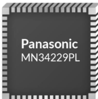
**Figura 8:** Sensor de imagens utilizado no APSCERR (equipamento cirúrgico portátil de comunicação automática com o robô R1T1)
