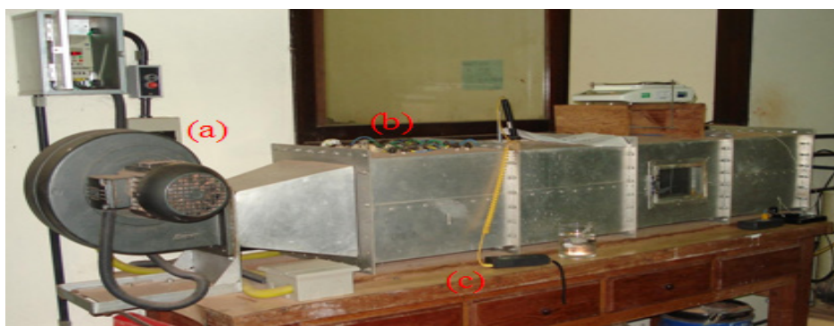
Figura 1: Vista frontal do secador tipo túnel com convecção forçada. (a) soprador; (b) resistências; (c) termopar.
