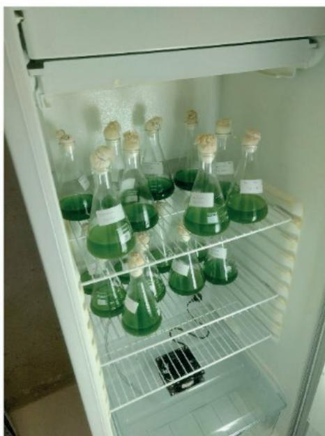
Figura 1 – Experimentos mantidos em estufas do tipo BOD.
