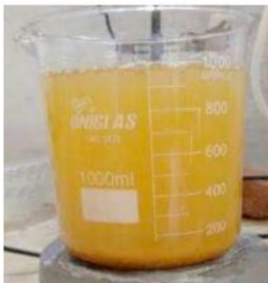
Figura 1 - Mistura reacional que indica a formação de óxido de grafeno
