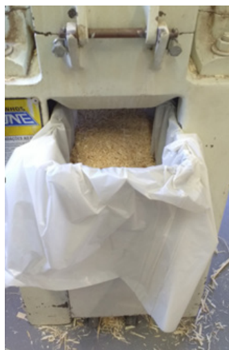
Figura 2 – Triturador utilizado para moagem do bagaço de cana-de-açúcar e do coco verde
