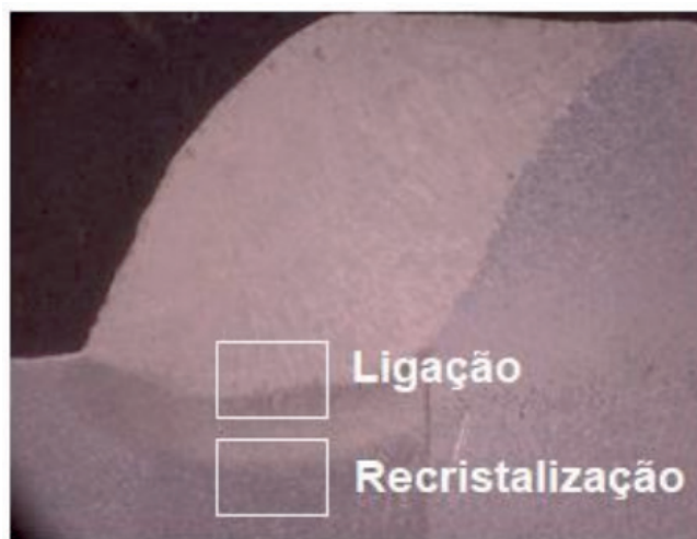
Figura 6. Secção da junta solda com \text{CO}_2 (Autores, 2018).
