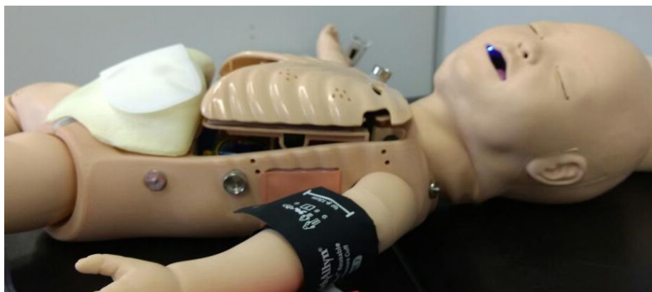
Figura 22 – Sistema com bolsas de ar sem inflação que simulam os movimentos respiratórios do SimBaby
