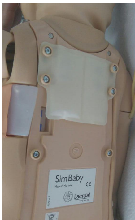
Figura 21 – Bolsa de ar que simula os movimentos de tronco do SimBaby
