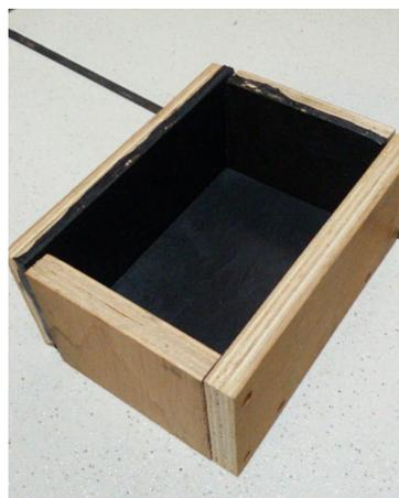
Figura 1. Fôrma de Compensado Revestida em seu Interior (PEDB).
