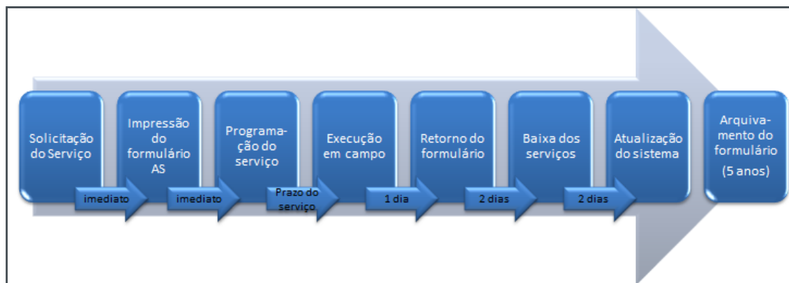
Figura 5: Fluxo do processo do documento AS impresso
