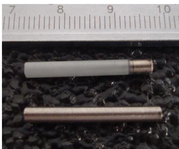
Figura 7 – Amostra sem tratamento (amostra inferior) e com tratamento (amostra superior) (Autoria própria).
