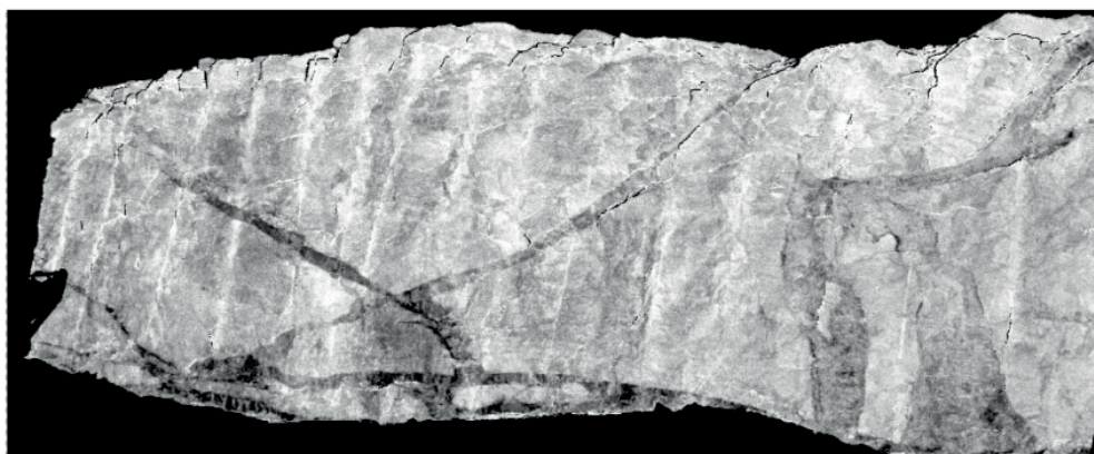
Figura 4 – Bancada de avanço de lavra representada pela nuvem de pontos de reflectância.
