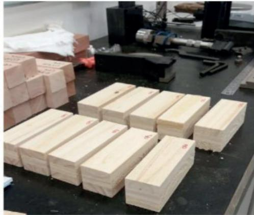
Figura 6: Corpos de prova de CLT
