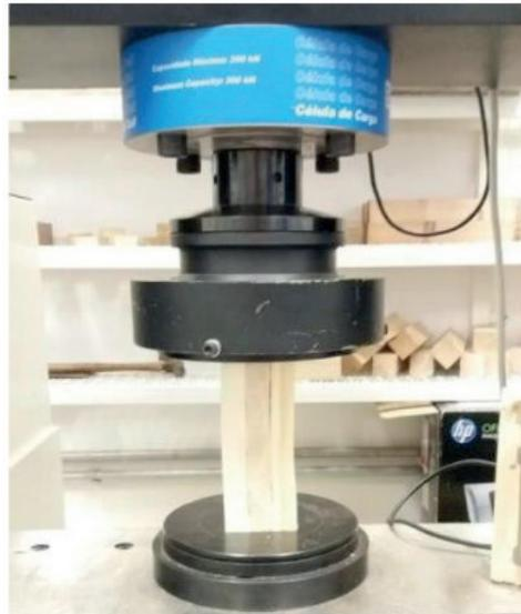
Figura 9: Ensaio de compressão paralela às fibras
