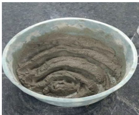
Figura 8 – Argamassa com adição de amaciante.
