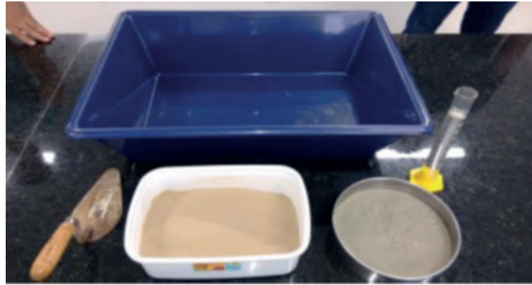
Figura 3 – Preparação para moldagem dos corpos de prova.
