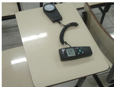
Figura 7: (a; b) Sala de aula 105-A com 06 luminárias e 12 lâmpadas fluorescentes de 40W cada; (c) Medição realizada
