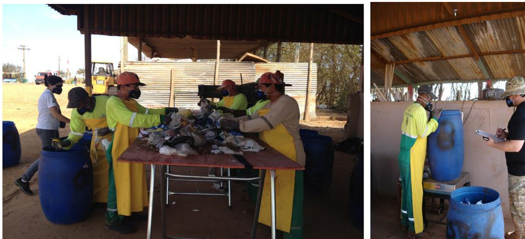
Figuras 6a e 6b – Amostragem, separação e pesagem individual das amostras
