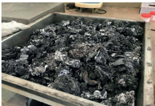
Figura 3: Escória de alumínio secundária coletada e resfriada.
