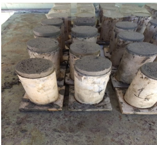
Figura 5: Momento da moldagem dos CPs.
