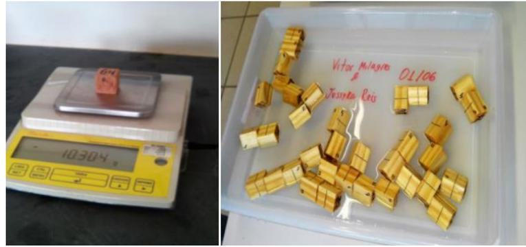
Figura 1: Dispositivo utilizado para pesagem e o início do processo de saturação em água das amostras.
