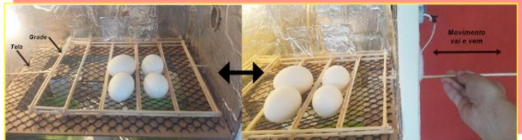
Figura 3: Grade e base de apoio superior (tela) para instauração dos ovos galados
