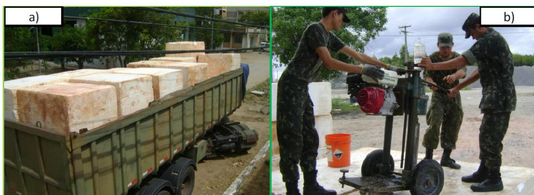
Figura 5. Corpos de prova de EPS: (a) transporte, (b) extração.
