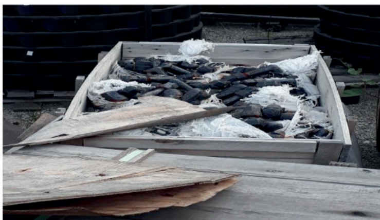
Figura 02: Parafusos de utilização da Junta travada externa
